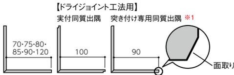
※1ドライジョイント工法の突き付け納め以外には使用できません。(シーリング納め使用不可) 小口部分の塗膜がはがれる可能性があります。
