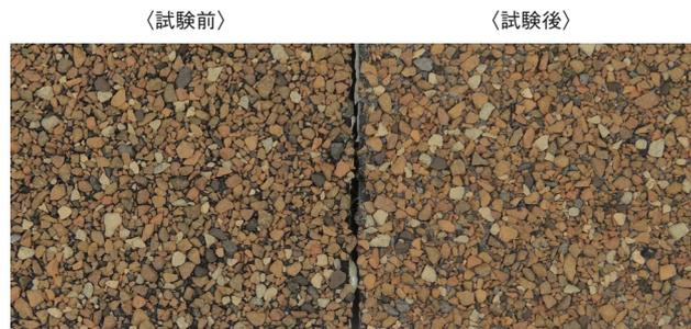
目視による本体の外観確認で異常(塗膜剥離による白化現象)なし。
